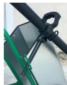
Détail du support de lance réglable
