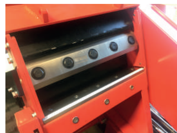
Détail du rotor avec couteaux et contre-couteaux
