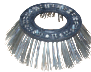
brosse dure 030 entièrement équipée de méplats en acier, très abrasive, pour sols durs et sains.
